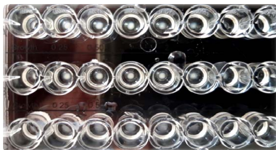
Obr 1 Mikrodilučná metóda stanovenia citlivosti na kolistín
